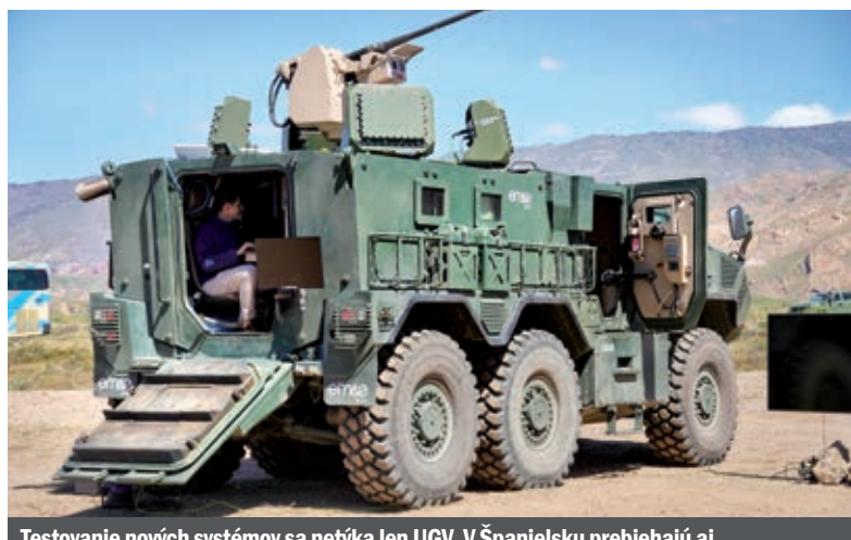
Testovanie nových systémov sa netýka len UGV. V Španielsku prebiehajú aj skúšky protidronového vozidla Odín, využívajúceho podvozok 6×6 spoločnosti EM&E.
