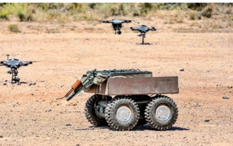
UGV Adriano disponuje výbušným zariadením, určeným na odstraňovanie prekážok
