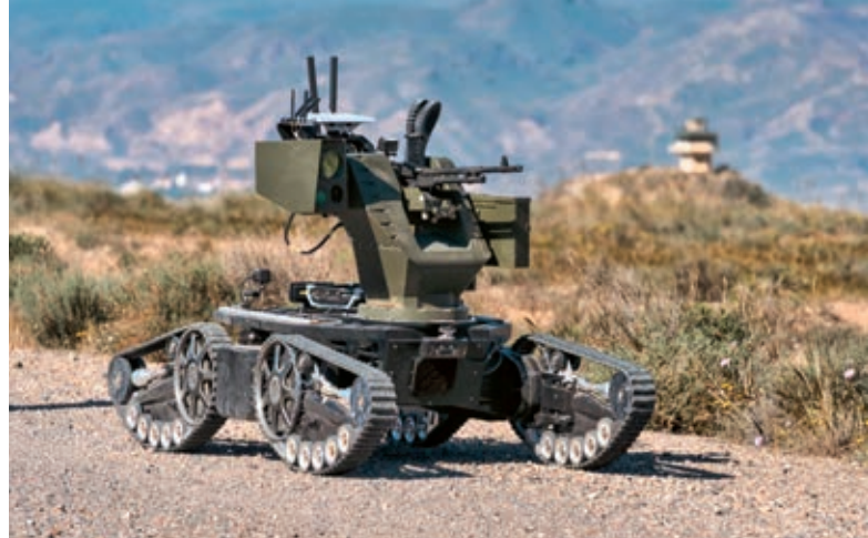
Rodina vozidiel AUNAV je vybavená dvojitým pásovým podvozkom. So streleckou vežou Aspís slúžia na podpornú paľbu.
